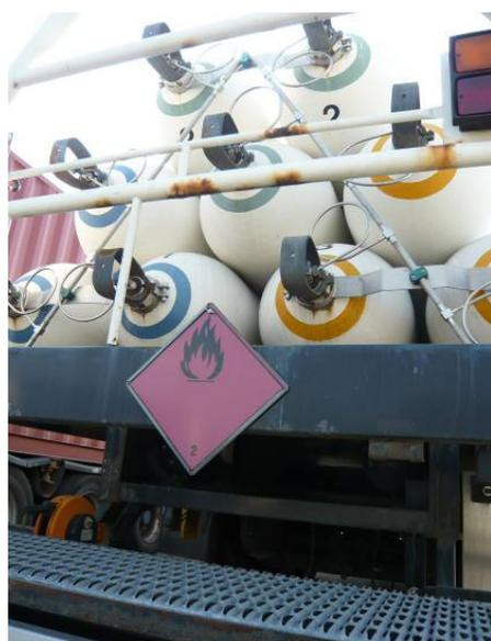
Abb. 5 Batteriefahrzeug für brennbare Gase
