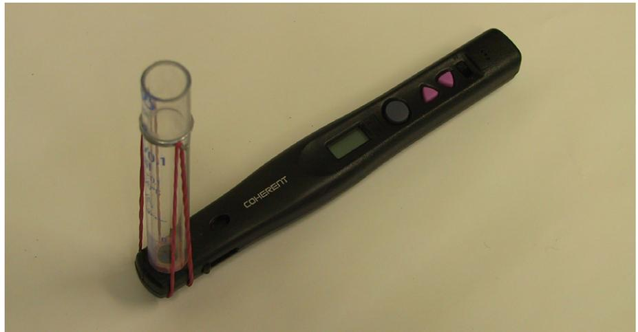
Abb. 1 Mobile optische Bank mit Laserstrahlungsleistungsmessgerät
