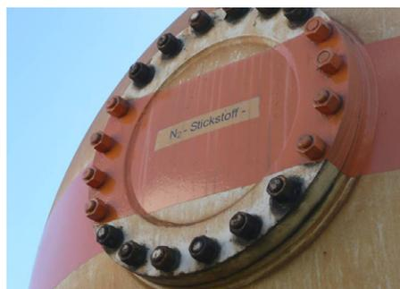
Abb. 4 mit Stickstoff inertisierter leerer Eisenbahnkesselwagen für verflüssigte Gase
