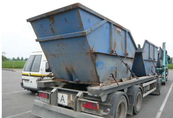
Abb. 4 Absetzbehälter - Fahrzeug mit Absetzbehältern bei einer Depo- niekontrolle
